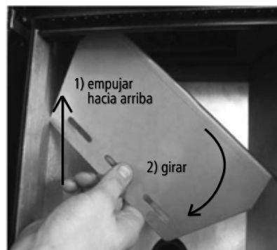
Fig. 17: extracción de la placa cortafuego
